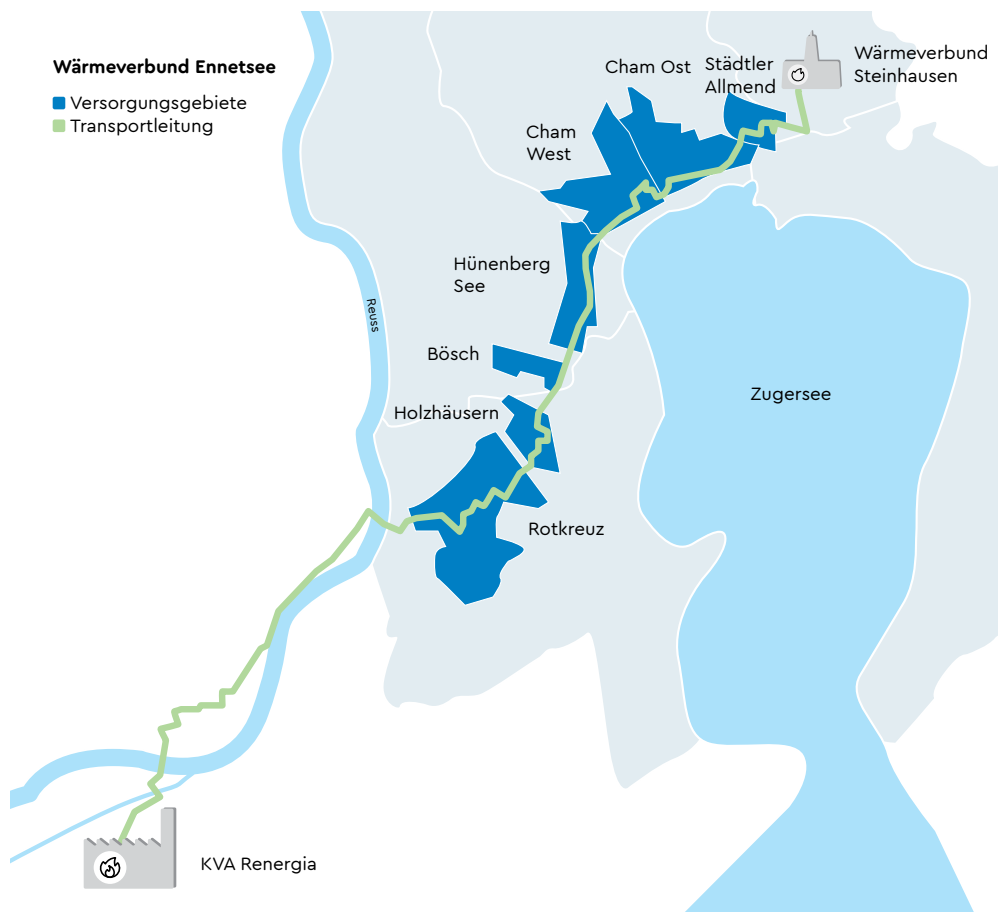
Die Transportleitung führt von Perlen (LU) nach Rotkreuz und erschliesst den Ennetsee bis und mit Städtler Allmend mit CO 2 -neutraler Fernwärme. Die Feinverteilung der Wärmeenergie in die Quartiere und zu den Gebäuden erfolgt über Verteilnetze. Das gesamte Leitungsnetz (Vor- und Rücklauf) hat im Endausbau eine Länge von fast 90 Kilometern.
